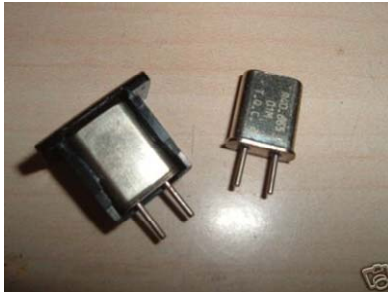
Fig. 4.14. Cristales usados en osciladores y filtros
